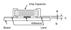
a=20~70μm b=30~35μm c=50~105μm
